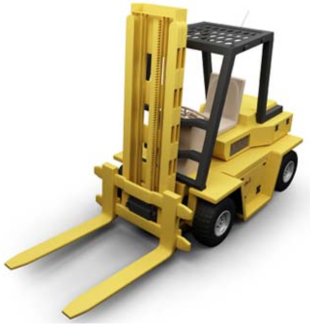
Figura 2.3. Ejemplo de una carretilla montacargas, perteneciente a los equipos Grúas (La carga es elevada y bajada).
