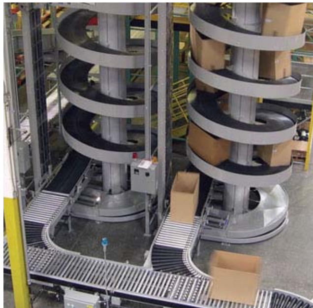
Figura 2.2. Ejemplo de una carga desplazándose en un transportador tipo caracol (La carga es transportada a lo largo de equipo).
